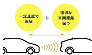
ACC (アダプティブクルーズコントロール) を使用する場合は、上り坂などでスピードが低下した場合、自動で加速してくれるので一定の速度を維持できるので便利ですね。
