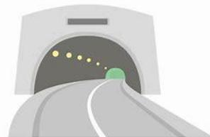
トンネル内の非常口は、事故や火災といった緊急時の避難用通路として、一般的なトンネルでは300m間隔、長いトンネルでは750m間隔で設置されることが決められています。
