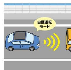
車間距離を保って前車に追従。前者がスピードを落とせば、こちらも自動的に速度を調整してくれるから、交通が流れている時もノロノロ運転の時でも運転のストレスが低減します。
